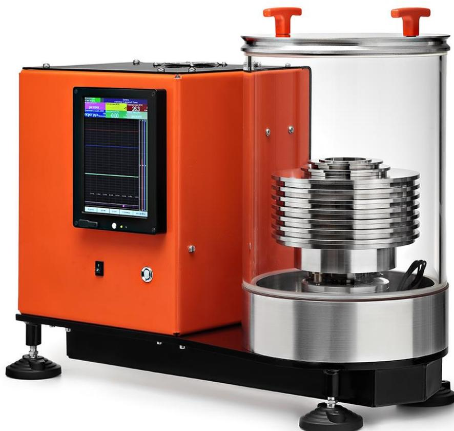
Поверка и калибровка средств измерения абсолютного и избыточного давления: калибраторов давления, барометров, измерительных преобразователей давления (датчиков), цифровых манометров, грузопоршневых манометров, классов точности 0,008 и грубее в диапазоне от  $-0,1$  до 10 МПа.
