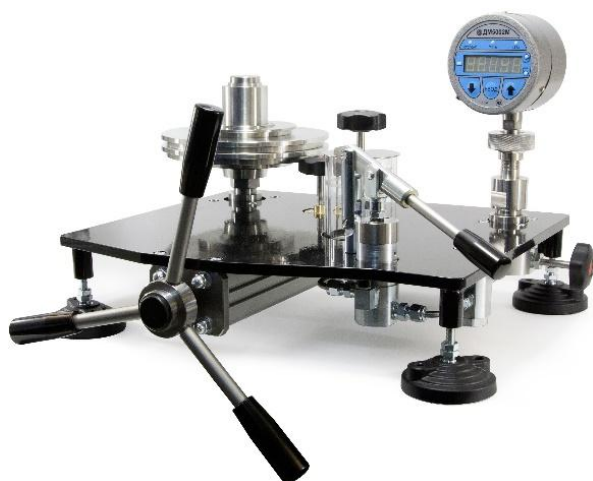
УСД исполнения для высокого давления
