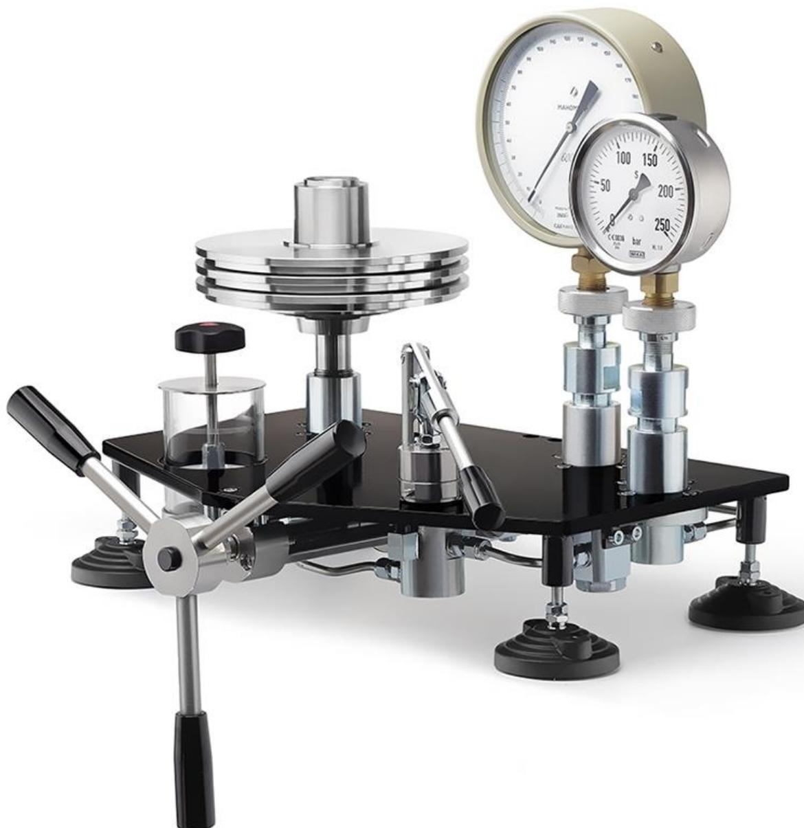
Грузопоршневой манометр МП-1600 предназначен для поверки и калибровки средств измерения избыточного давления: калибраторов давления, измерительных преобразователей давления (датчиков), образцовых и технических манометров, грузопоршневых манометров.
