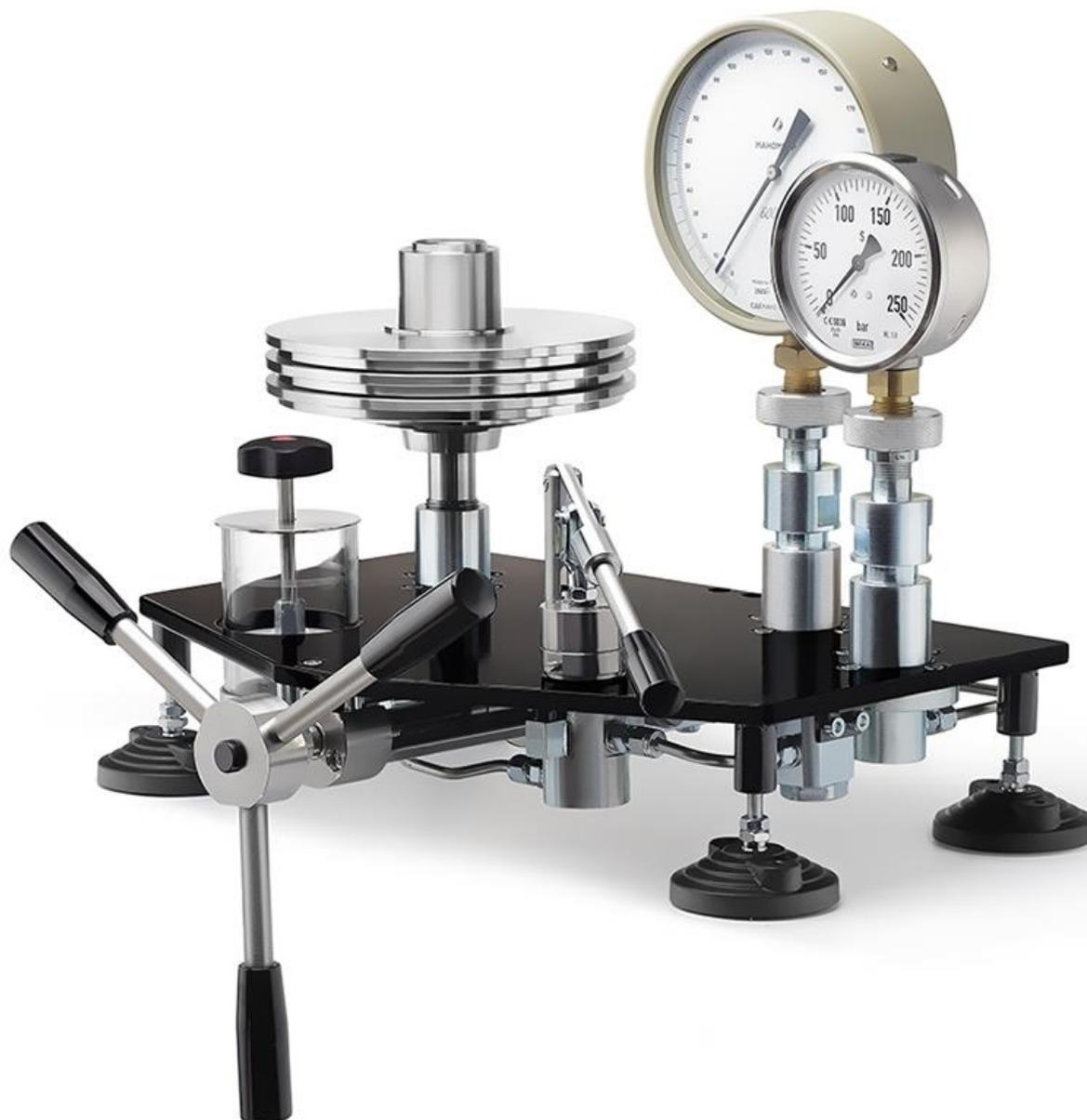
Грузопоршневой манометр МП-1000 предназначен для поверки и калибровки средств измерения избыточного давления: калибраторов давления, измерительных преобразователей давления (датчиков), образцовых и технических манометров, грузопоршневых манометров.
