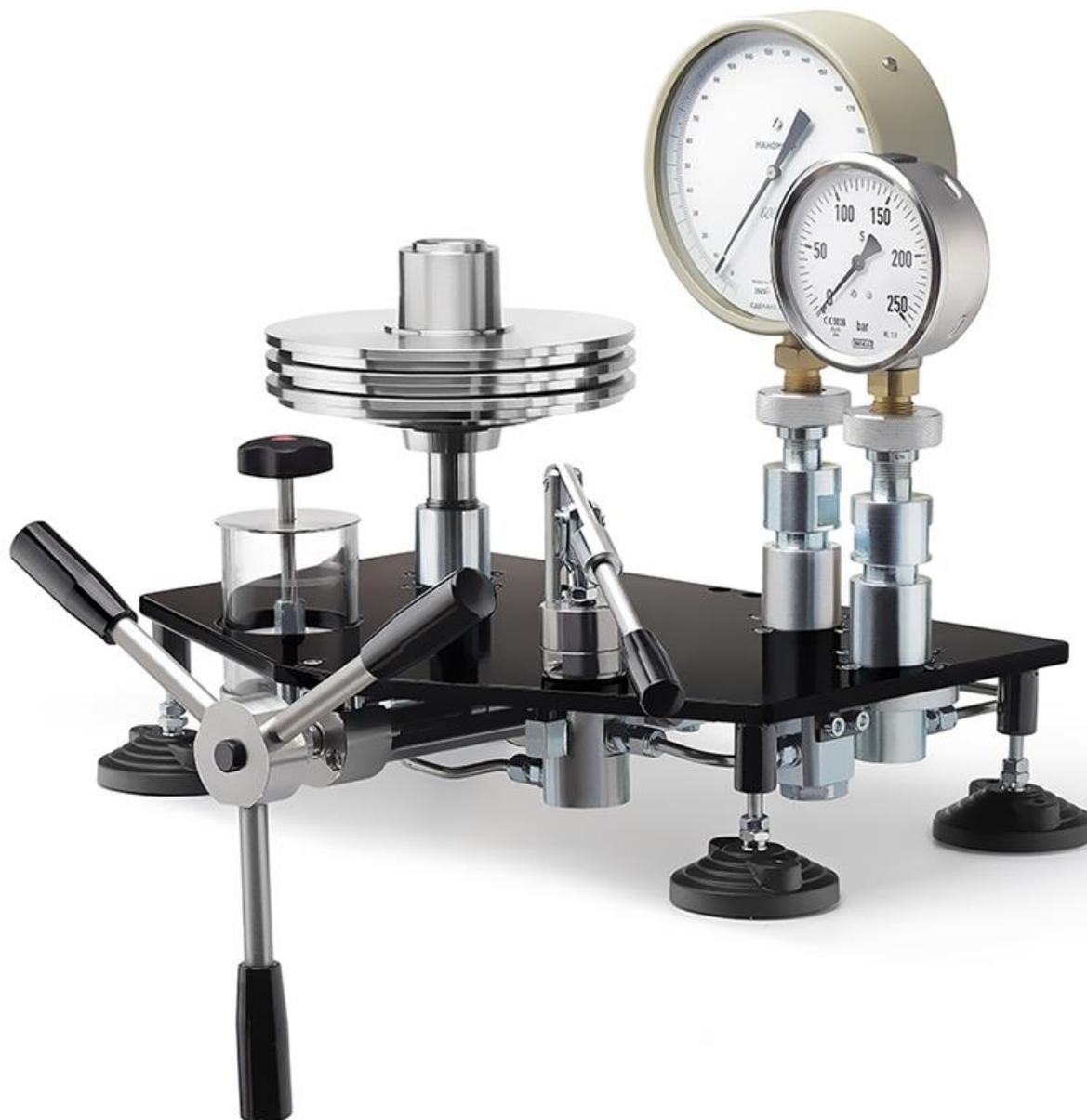
Грузопоршневой манометр МП-60 предназначен для поверки и калибровки средств измерения избыточного давления: калибраторов давления, измерительных преобразователей давления (датчиков), образцовых и технических манометров, грузопоршневых манометров.
