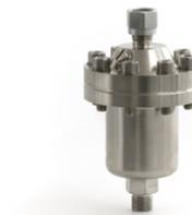
Разделитель сред «жидкость/газ» РПГ предназначен для проведения калибровок и проверок средств измерения давления, не допускающих попадания внутрь жидкости (в том числе пищевого исполнения, кислородного исполнения, специального исполнения). Разделитель устанавливается непосредственно на гидравлическое устройство, требует подключения к источнику питания (баллон сжатого газа или компрессор). Максимальное давление 25 МПа.
