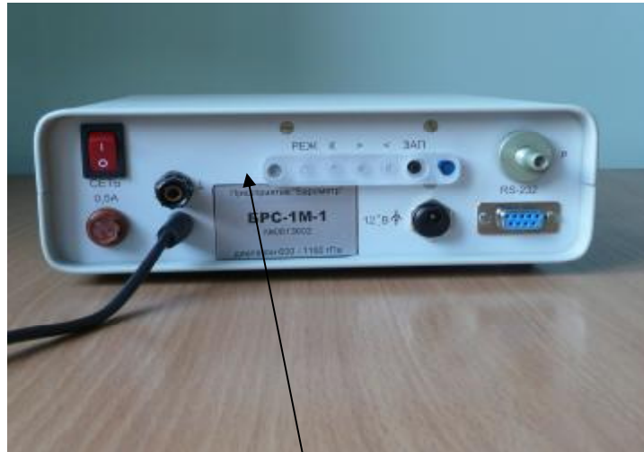
Рисунок 3 - Место нанесения пломбы на крышку кнопок коррекции барометра БРС-1М.
