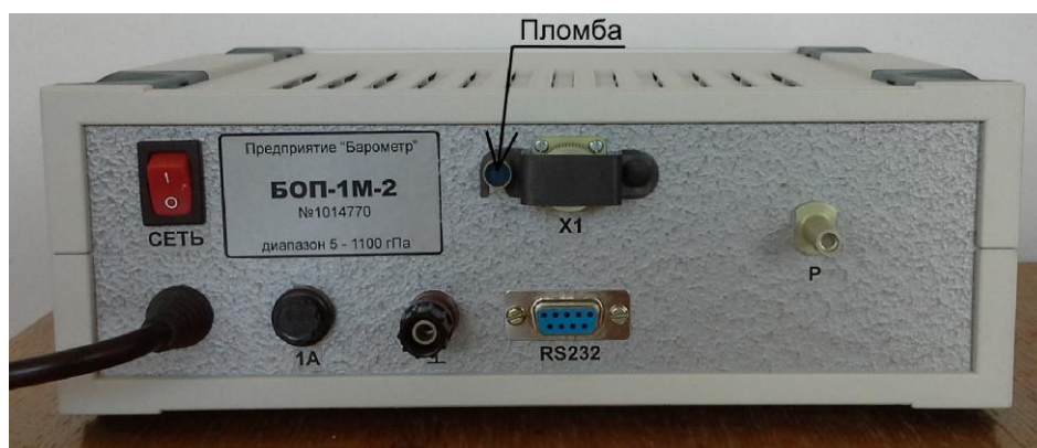
Рисунок 3 - Место пломбирования барометров образцовых переносных БОП-1М
