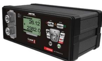
Рисунок 7. Калибратор давления Crystal модель nVision (настольное исполнение)
