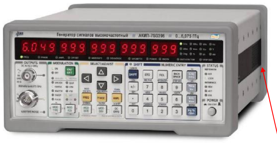
место пломбирования (защитная наклейка)
