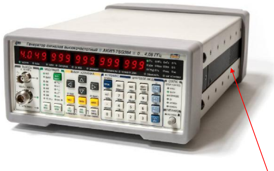
место пломбирования (защитная наклейка)
