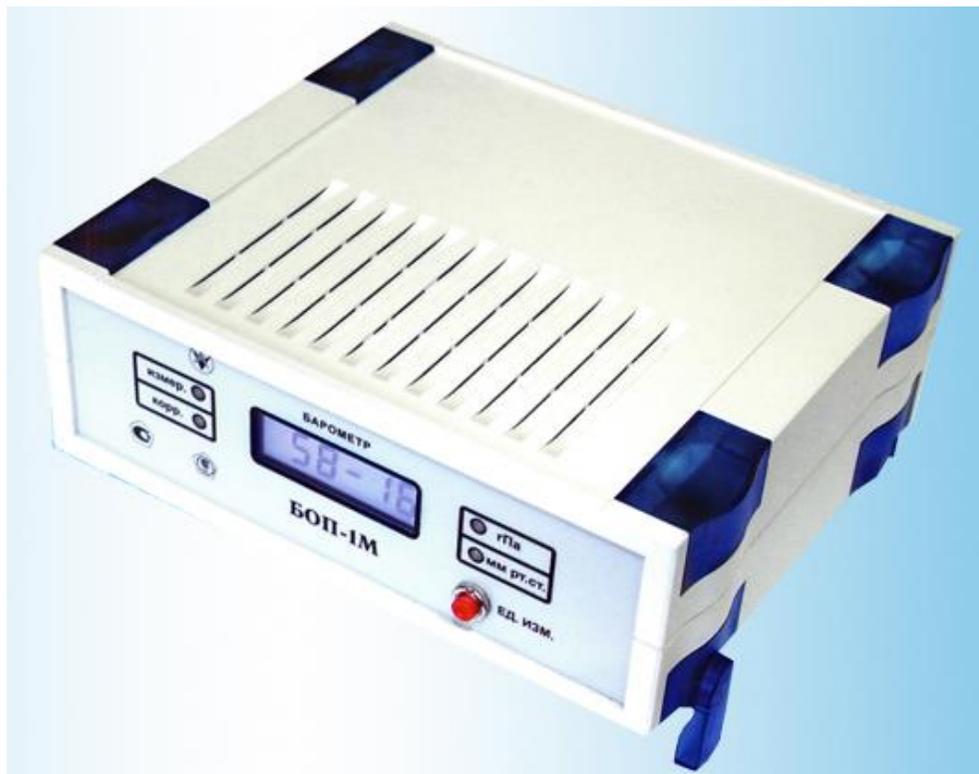
Барометры образцовые переносные БОП-1М предназначены для измерения абсолютного (атмосферного) давления. Барометры являются рабочими эталонами первого разряда в соответствии с ГОСТ Р 8.840-2013 ГСИ. Государственная поверочная схема для средств измерения абсолютного давления в диапазоне от 1 Па до 1 МПа.
