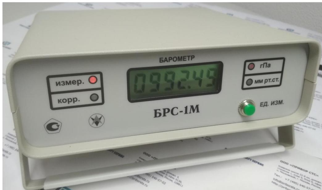
Барометр рабочий сетевой типа БРС-1М предназначен для измерения атмосферного давления на метеостанциях аэропортов и службы прогноза погоды, экологических станциях. Может использоваться для поверки общепромышленных датчиков и приборов измеряющих давление.
